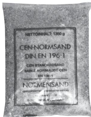
Der typische Normensand PE-Beutel mit 1350 g Inhalt zur Herstellung genormter Zementmörtel-Prismen. / The typical polyethylene bag for standard sand with 1350 g contents for the manufacturing of standardized cement mortar prisms.
